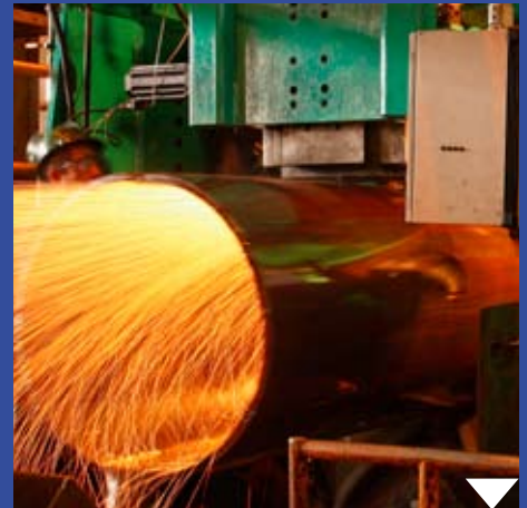
Proceso de soldadura por Resistencia eléctrica de alta frecuencia HFW
