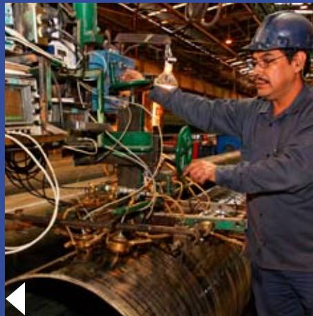
Inspección por Ultrasonido.
