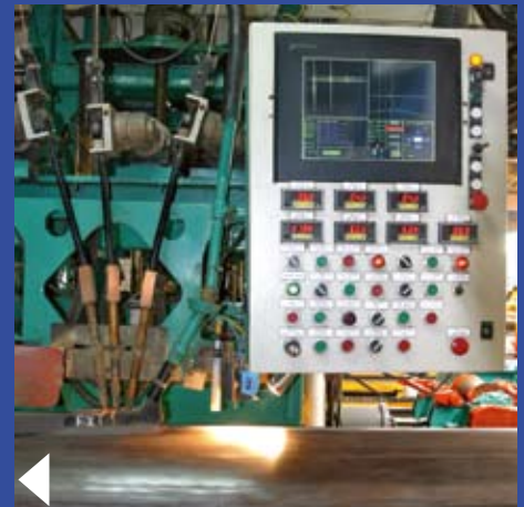
Proceso de soldadura de Arco Sumergido SAW exterior
