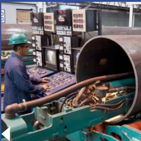
Proceso de soldadura de Arco Sumergido SAW interior
