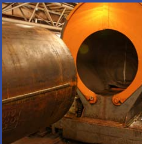
Inspección con Rayos X en ambos extremos del tubo
