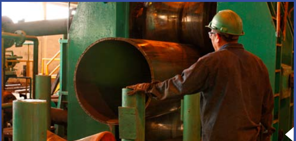
Salida de la tubería del molino
