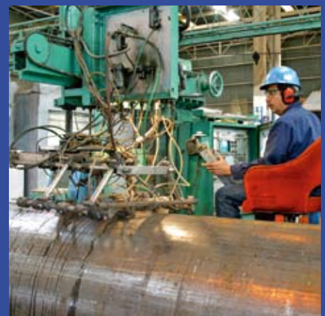
Inspección Ultrasónica final del 100% de la longitud del tubo
