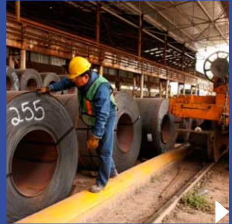
Recepción y almacenaje de Materia Prima, ya sea en rollos o placas de acero.
