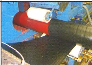
Aplicación Tricapa Poliétileno Three-Layer Polyethylene Coating
