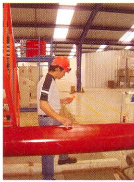
Medición de Espesor de Recubrimiento Coating Thickness Test
