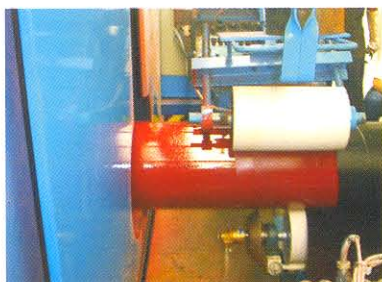
Aplicación de las tres capas de Recubrimiento Three-Layer coating application
